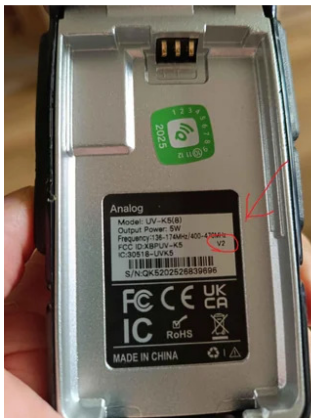
Пример маркировки V2 под аккумулятором. Источник: изображение из README K5TOOL/GitHub.
